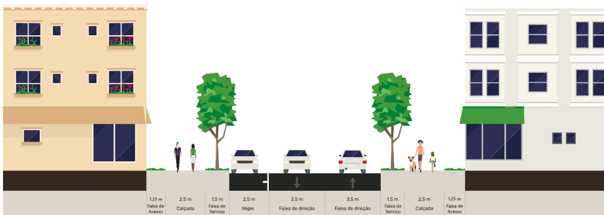
Figura 8: Perfil via coletora 20m sem ciclovia
